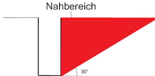
**Abbildung 1:** Prinzipschnitt Kanalgraben
